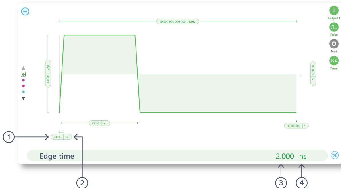
Figure 21. Waveform Generator edge time parameter
